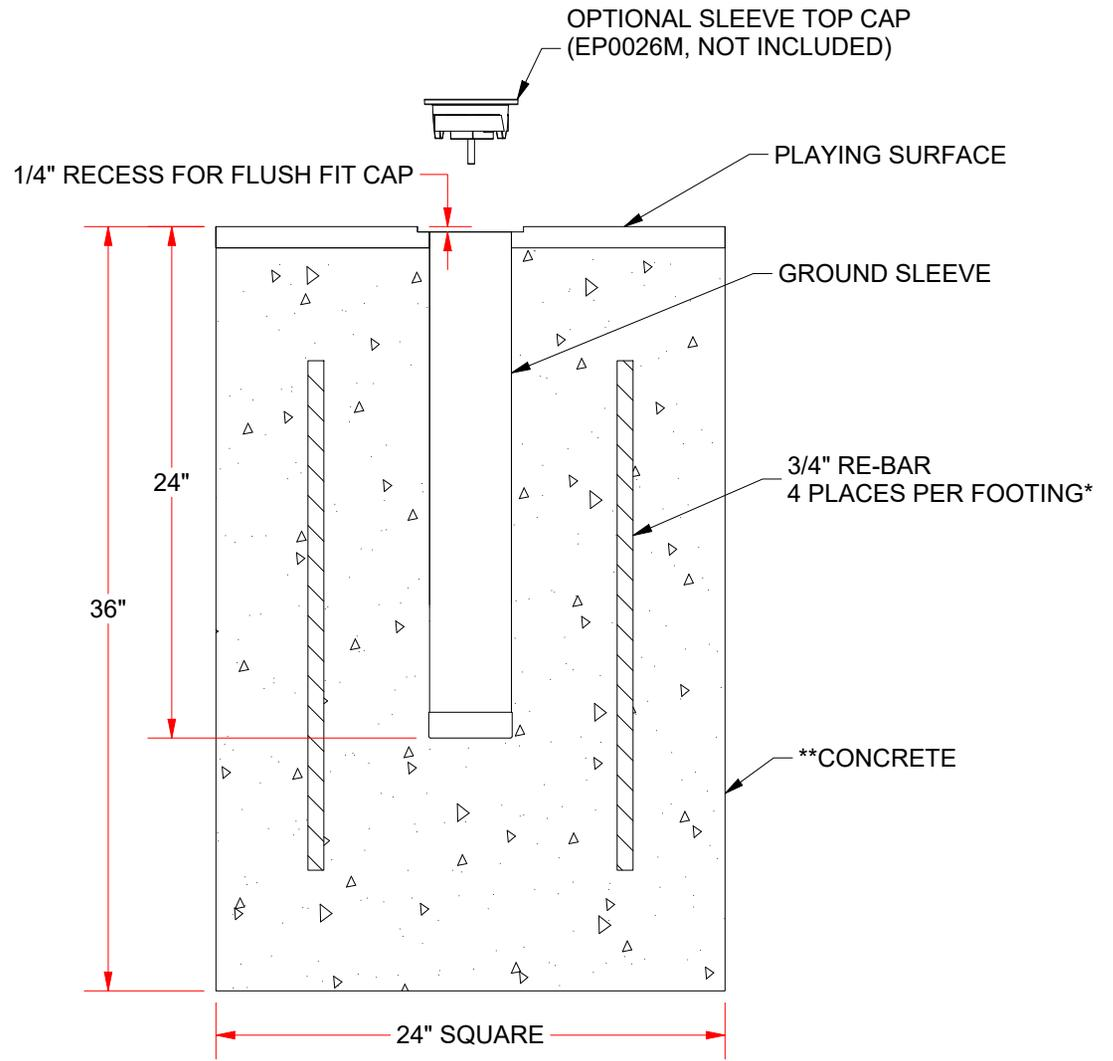
\*\*CONCRETE SPECIFIED SHOULD BE 400# MIN.
