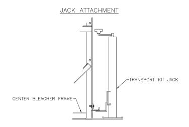
PLACE JACK ON UNDER SIDE OF HORIZONTAL BRACE APPROX. 14"-18" AWAY FROM CENTER FRAME, AS SHOWN. BLEACHER SHOULD ALWAYS BE ON SOLID, LEVEL GROUND , AND BE STABILIZED TO PREVENT MOVEMENT WHEN USING JACK.
